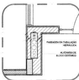
2 DETALHE - SHAFT HIDRÁULICA ESCALA 1:20
